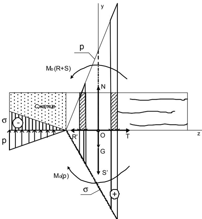
Рис. 1. Система уравновешенных сил, приведенная к центру O
