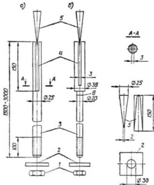
Рис. 4. Конструкция клинощелевых анкеров:
