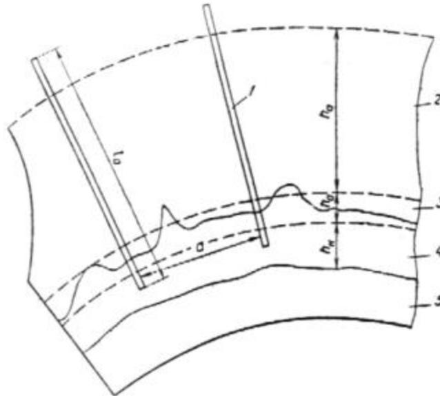
Рис. 15. Конструкция комбинированной анкер-набрызгбетонной крепи (обделки):
