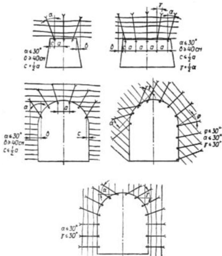
Рис. 6. Схема расположения анкеров при слоистой кровле
