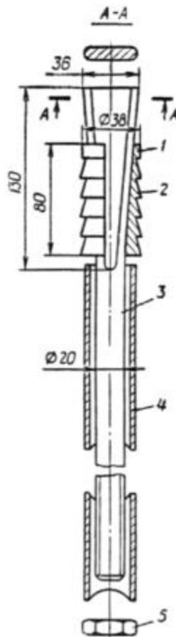
Рис. 5. Конструкция распорного анкера СКШ:
