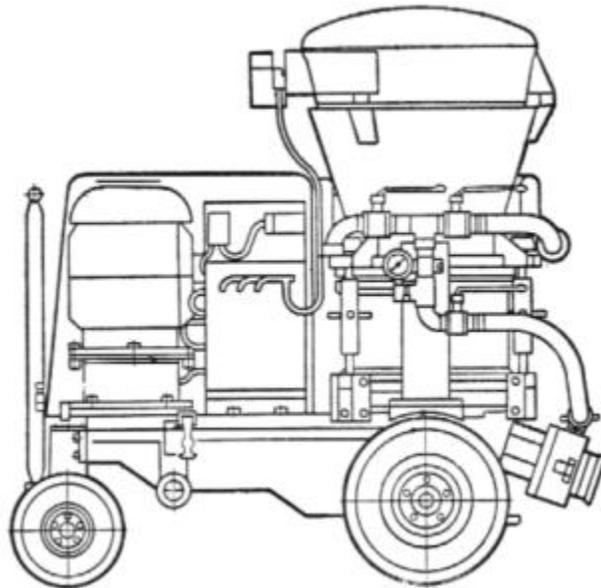
Рис. 2. Набрызгбетон-машина
