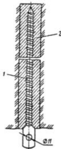
Рис. 7. Схема набивного железобетонного анкера:
