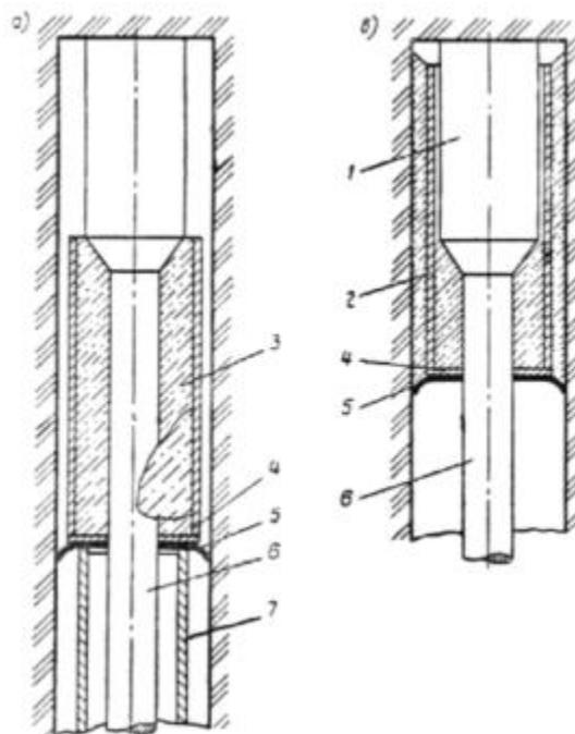
Рис. 14. Схема плунжерного корневого анкера типа «Перфо»:
