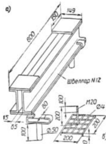
Рис. 1. Приспособление для определения сцепления набрызгбетона:
