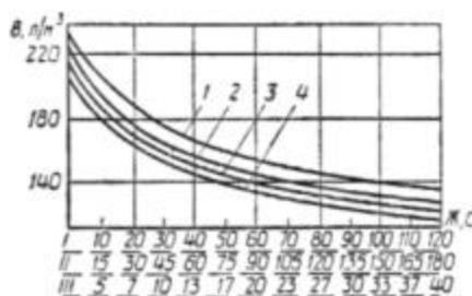
Рис. 1. График расхода воды на 1 м<sup>3</sup> бетонной смеси в зависимости от жесткости бетонной смеси:
